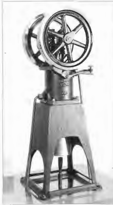
Heißluftmaschine für das Kleingewerbe, Leistung 0,05 PS, um 1920 Foto: Deutsches Museum
