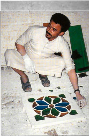
Mansour Al-Faqih bei der Herstellung eines Qamariya-Fensters
