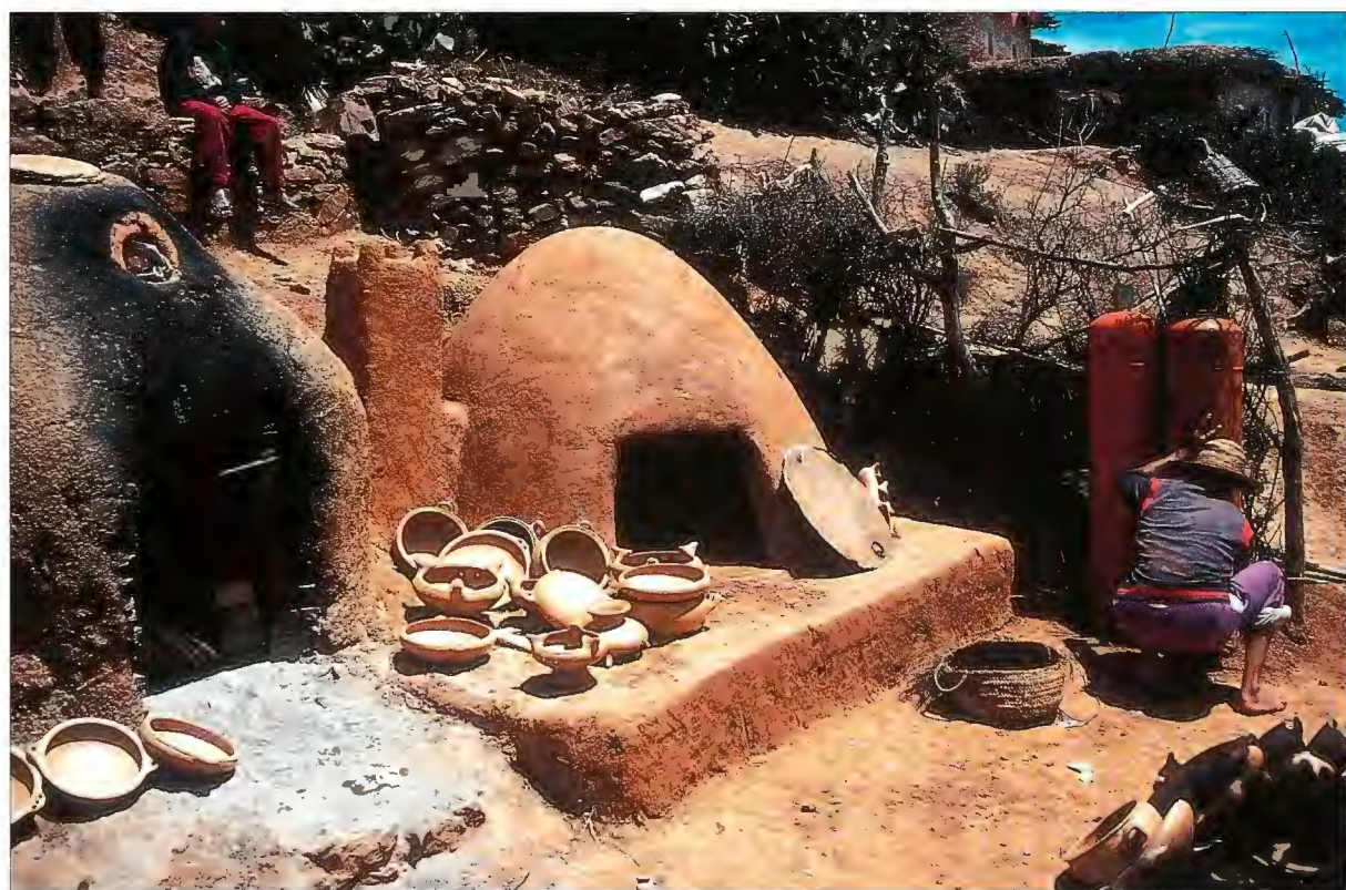
Neu gebauter Gasbrandofen, rechts; traditioneller Holzofen, links
