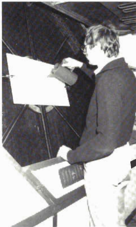
Beschichtung in der Schleuder mit Kopierflüssigkeit
